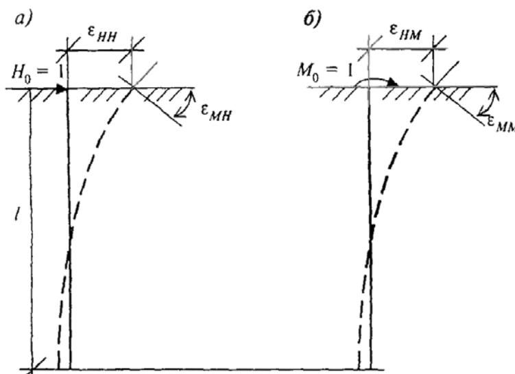
а) - перемещения от действия силы  $H_0 = 1$ , приложенной в уровне поверхности грунта; б) - перемещения от
